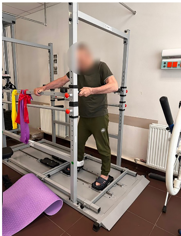
Рис. 2. Тренажер механический для реабилитации пациентов с последствиями заболеваний и травм опорно-двигательного аппарата (Тренажер Ильясова «ЛЫЖНИК»)
