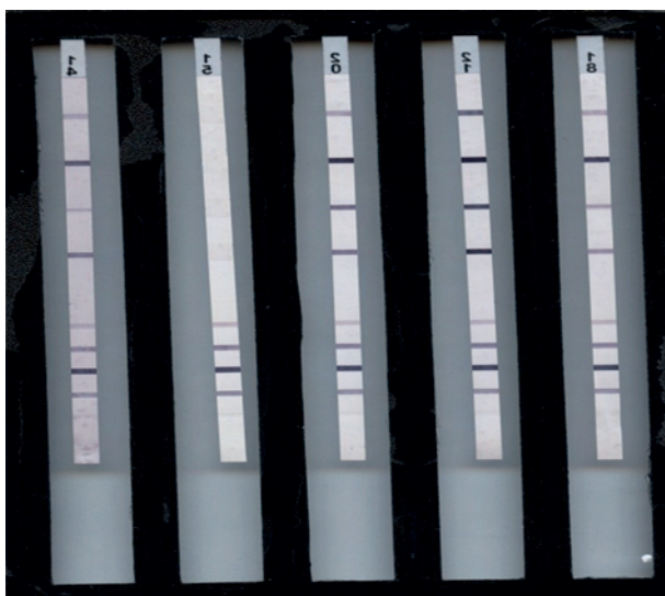
Рис. 2. Исходное изображение, получаемое при сканировании держателя с ИБ-стрипами, которое анализируется с помощью разработанного ПО
